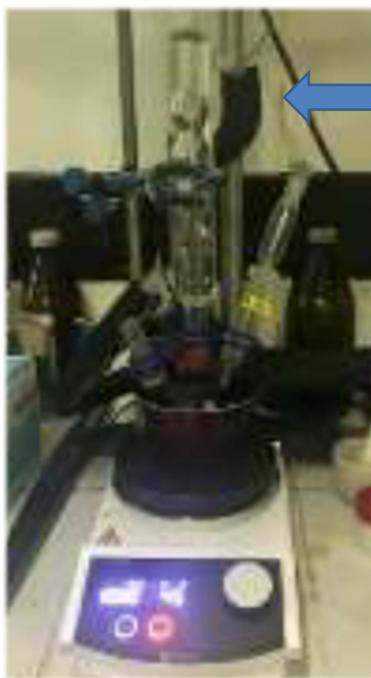
Синтез сверхшитых ароматических полимеров (САП) осуществлялся в трехгорлой круглодонной колбе путем одностадийной сшивки бензола, нафталина или их смеси с диметилацеталем формальдегида в течение суток. В качестве растворителя использовали 1,2-дихлорэтан, а в качестве катализатора полимеризации – безводный FeCl<sub>3</sub>, который хранится в атмосфере аргона.
