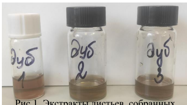
Рис.1. Экстракты листьев, собранных на ул. Троицкой, через 1 день после добавления \text{Ag}^+ . Соотношение объемов экстракта и \text{Ag}^+ : 1/0,5; 1/1; 1/2
