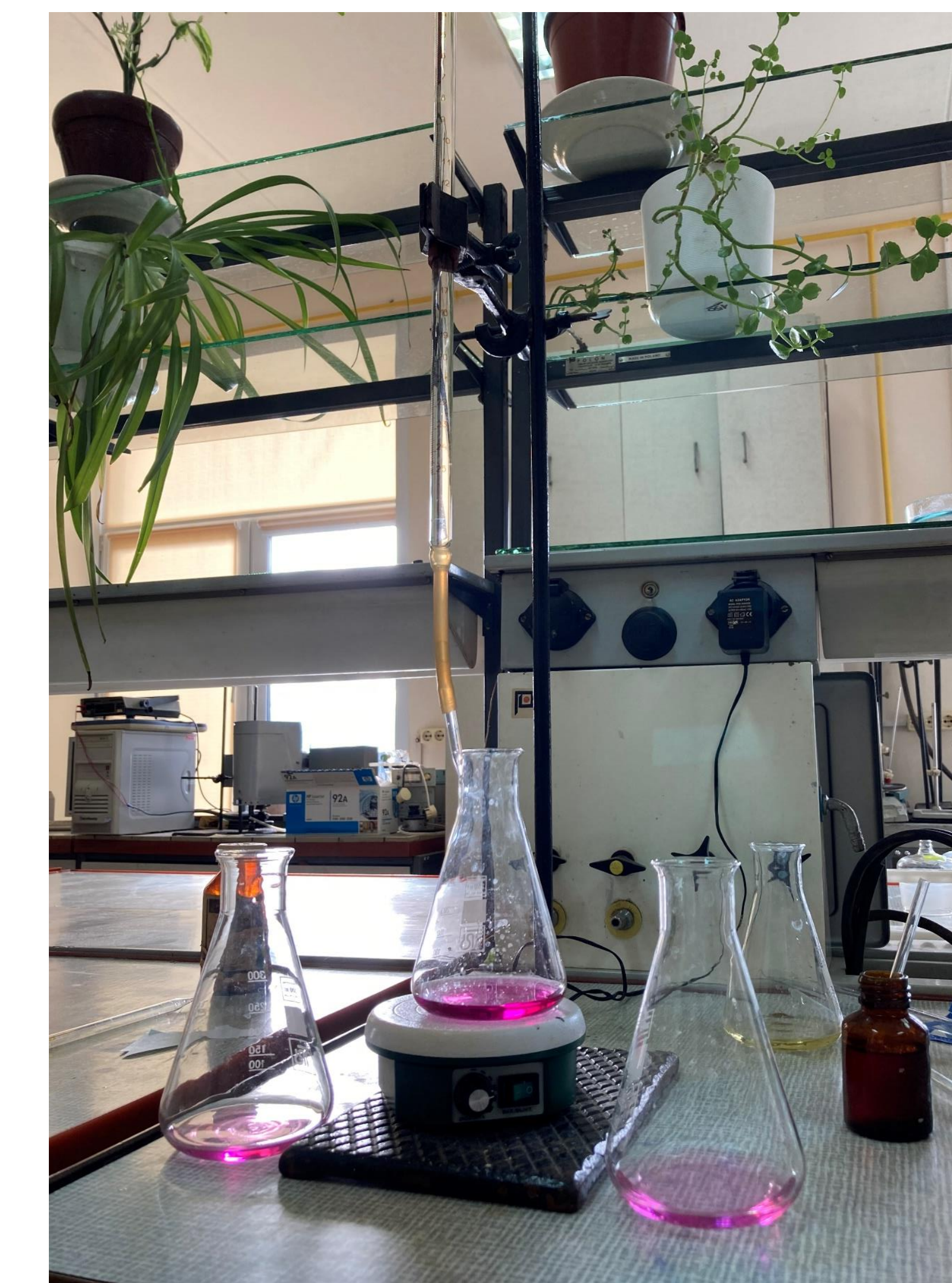
Рис. 2. Колбы с исследуемым раствором для титрования
