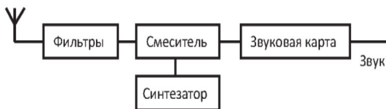
Рис. 1. SDR приемник с переносом спектра на низкую частоту.
