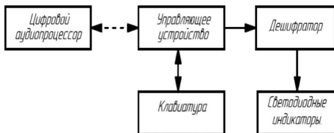
Рис. 1. Структурная схема панели индикации
