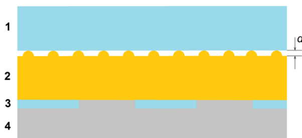
Рис. 1. Структура с подвижный электродом (ПЭ). 1 - ПЭ, 2 - сегнетоэлектрик, 3 - электрод,
