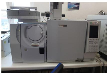
Рисунок 6 - Газовый хроматомасс-спектрометр GCMS-QP2010
