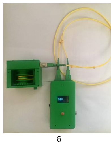
Рис. 1. Устройство измерения угловых величин: а – общая схема, б – процесс регистрации данных.
