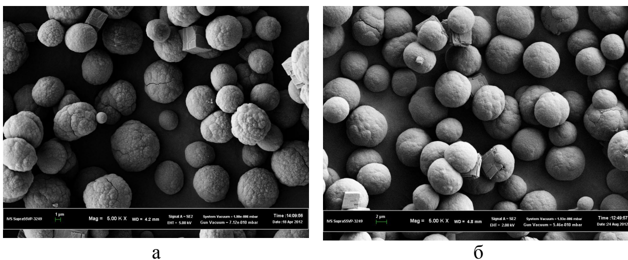
Рис.1. СЭМ–фото ядер, изготовленных при \Omega=300 rpm, t=10 s. Увеличение 5000. Ядра без белка (А); ядра, содержащие BSA ( L=55\mu\text{g}/\text{mg} ) (В)
