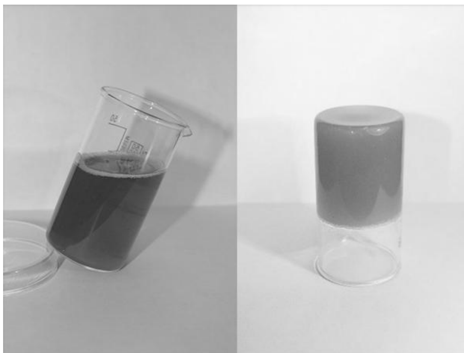
Рис. 1. Водно-щелочной 3% раствор хитина (слева) и гель (справа): раствор прозрачный, ржавого цвета, вероятно, из-за присутствия в исходном полимерном сырье пигментов.
