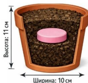
Рис. 2. Схематическое изображение горшка с почвой (высота 11 см, диаметр 10 см) и размещенной в середине ПМУ
