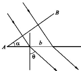
33. На щель ширины  $b$  положена стеклянная призма с показателем преломления  $n$  и преломляющим углом  $\alpha$  (см. рисунок). На грань  $AB$  призмы нормально падает плоская монохроматическая волна. Найти направления на нулевой максимум и минимума в дифракционной картине Фраунгофера.
