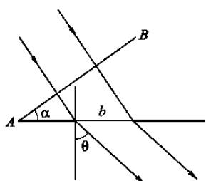
33. На щель ширины  $b$  положена стеклянная призма с показателем преломления  $n$  и преломляющим углом  $\alpha$  (см. рисунок). На грань АВ призмы нормально падает плоская монохроматическая волна. Найти направления на нулевой максимум и
