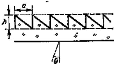
37. Рассчитать и проанализировать дифракционную картину при нормальном падении света на пилообразную решетку (см. рисунок), сделанную из стекла с показателем преломления  $n$ . Число зубьев решетки равно  $N$ ,
