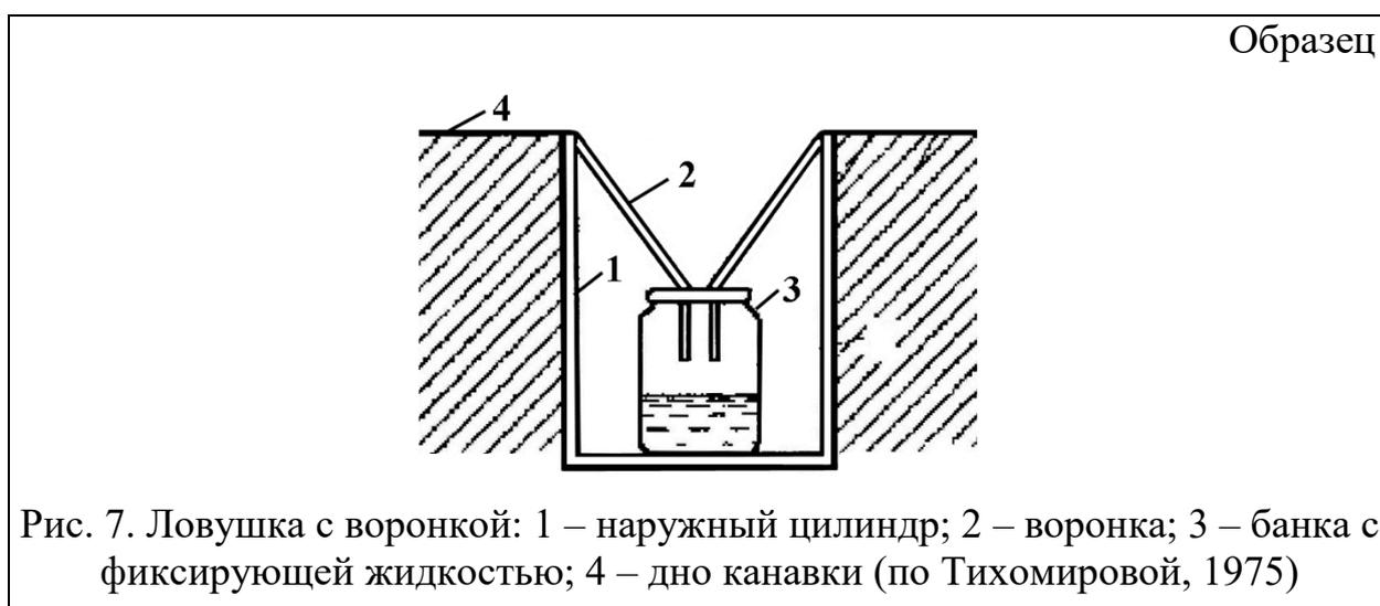
Рис. 7. Ловушка с воронкой: 1 – наружный цилиндр; 2 – воронка; 3 – банка с фиксирующей жидкостью; 4 – дно канавки (по Тихомировой, 1975)
