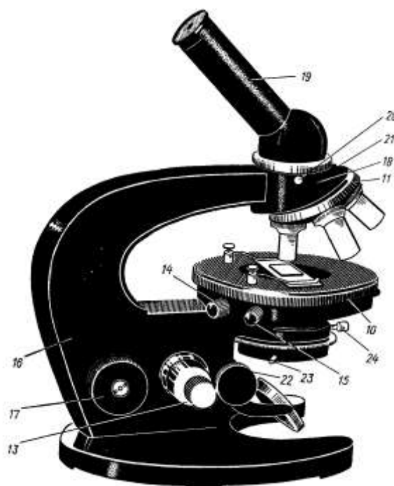
Рис.2. Микроскоп МБР-1. Внешний вид
