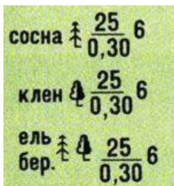
Рис. 21. Пример пояснительных топографических знаков
