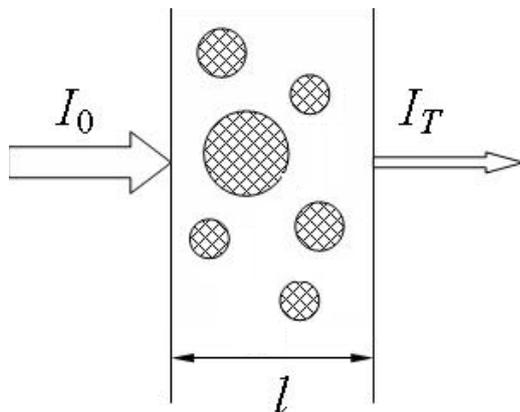
Рис. 1. Схема взаимодействия электромагнитного излучения с веществом
