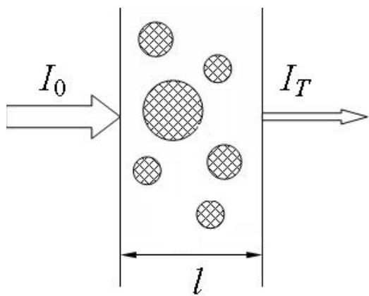
Рис. 1. Схема взаимодействия электромагнитного излучения с веществом
