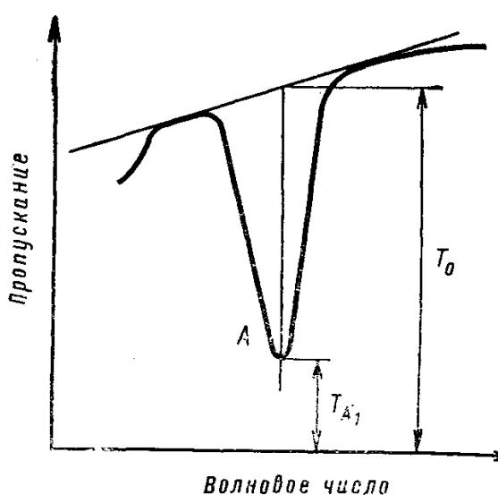
Рис. Пример обработки ИК спектра по методу базовой линии
