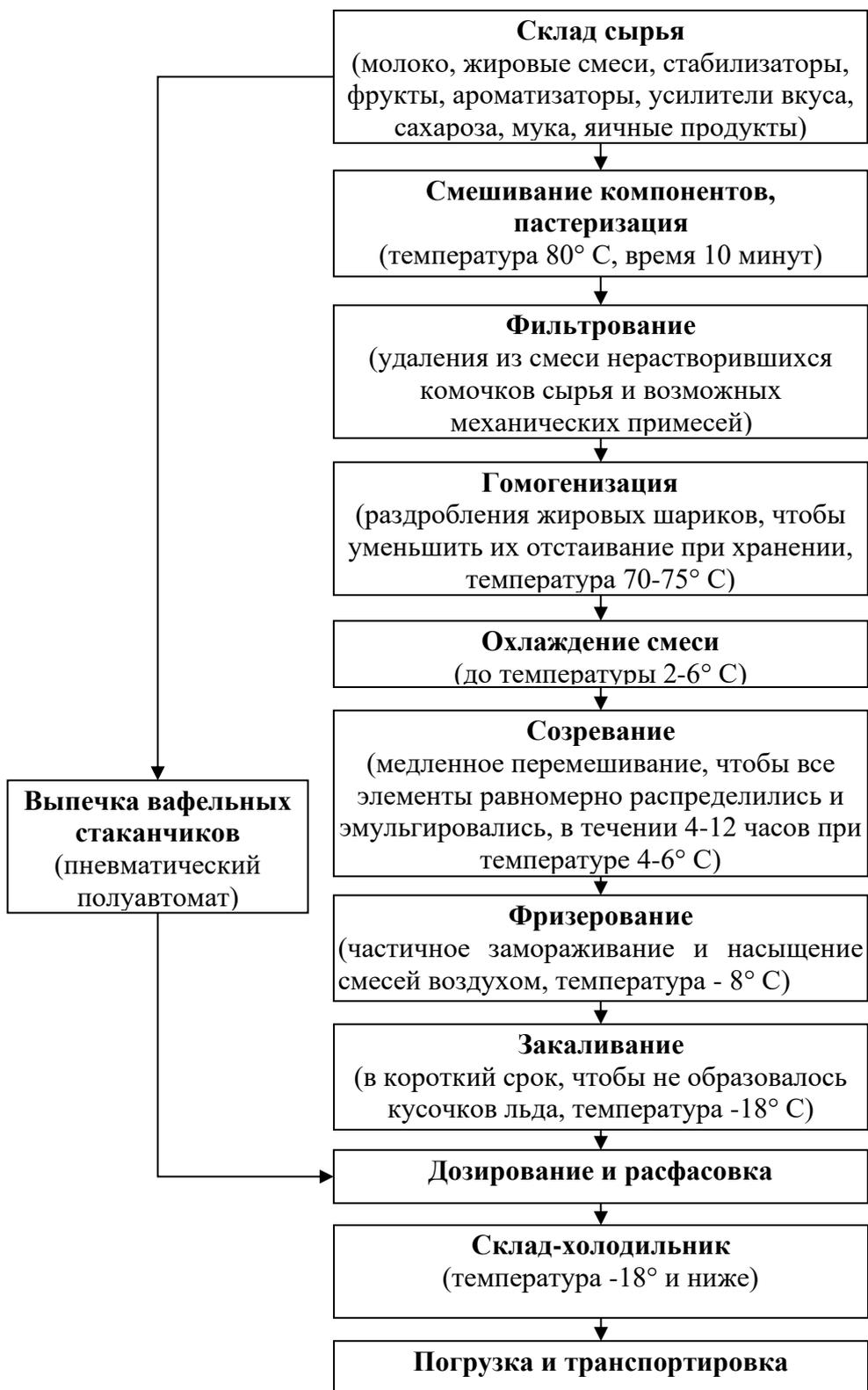
Рис. 1. Схема технологического процесса производства мороженого
