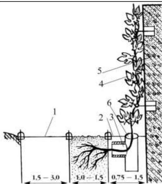
При подведении побегов лиан под покрытием тротуара от посадочных мест до здания укладывают керамические трубы диаметром 12 – 16 см, через которые и пропускают стебли к стенам. В местах выхода растений на поверхность оставляют в покрытии отверстия тоже около 16 см в диаметре.
