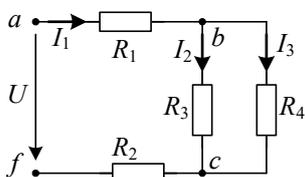
3. Как изменится ток  $I_2$ , если при неизменном значении напряжения  $U_{af}$  уменьшить сопротивление  $R_4$ ?
