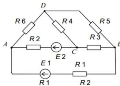
1. Рассчитать токи во всех ветвях схемы методом контурных токов. Правильность расчёта проверить составлением баланса мощностей.
