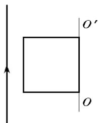
10. Квадратная рамка и прямой проводник лежат в одной плоскости как показано на рисунке. По проводнику протекает ток силой 40 А. Сторона рамки равна 8 см. Найти заряд, протекающий в рамке, при ее повороте на  $180^\circ$  вокруг оси  $OO'$ , отстоящей от проводника с током на расстоянии 10 см. Сопротивление рамки 2 Ом.
