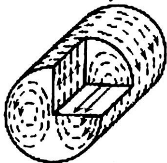
Рис. 8. Распределение полей в резонаторе E_{110} . Линии напряженности диода Ганна магнитного поля изображены прерывистыми линиями, электрического – непрерывными
